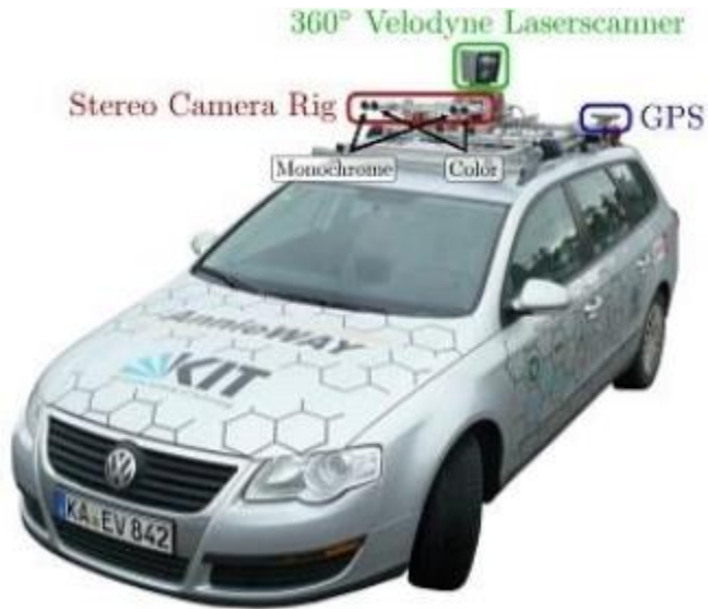
[ LiDAR 및 Stereo 카메라 기반 시스템 ]
